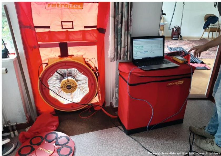
Met een grote ventilator wordt het huis onderzocht op kieren.
