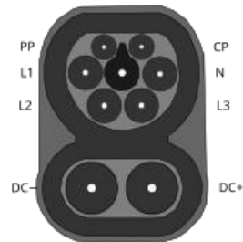
CCS Base combinada AC/DC Tipo 2 en el vehículo. IEC 62196
